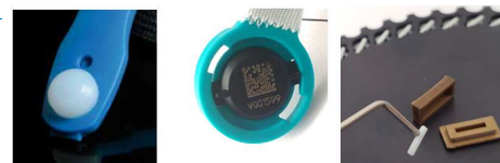
Abb. 1: TLD Eye-D™ Radcard (links), OSL/ALD (mitte), hauseigene MCP-N TLD# mit Halterung (rechts)
